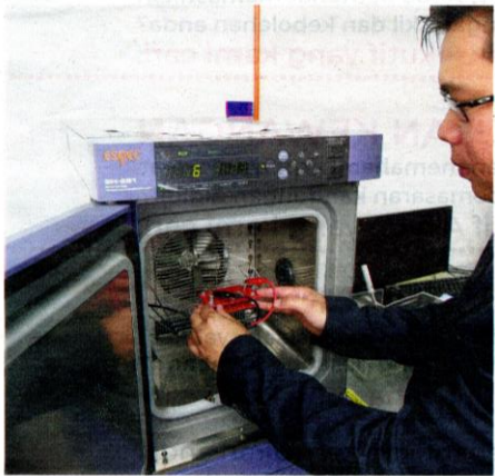
KEBUK kelembapan digunakan bersama-sama sistem pengukuran sensor untuk menilai prestasi kelembapan yang dihasilkan pada julat yang berbeza.
