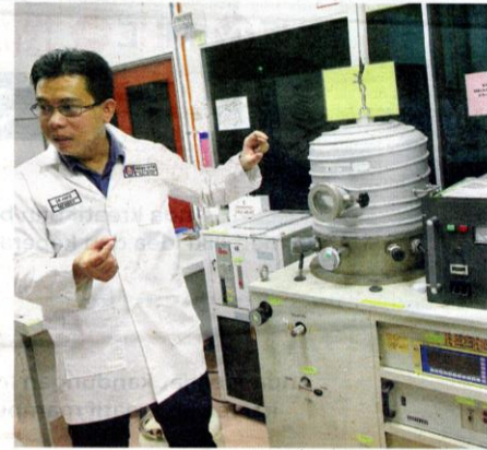
ALAT thermal evaporator yang digunakan untuk menghasilkan metal film nipis.
